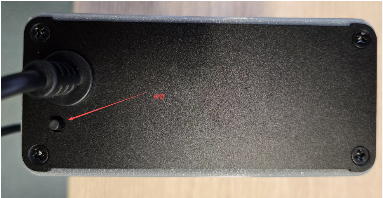
图 8 终端电阻切换按键位置
