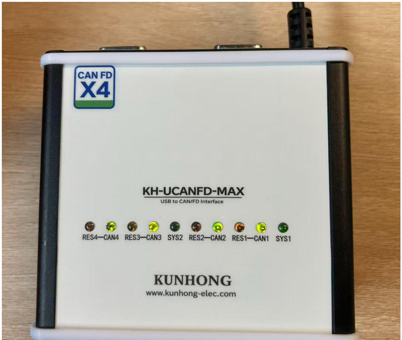
图 7 RES1、RES2、RES3、RES4 终端电阻全部开启示例
