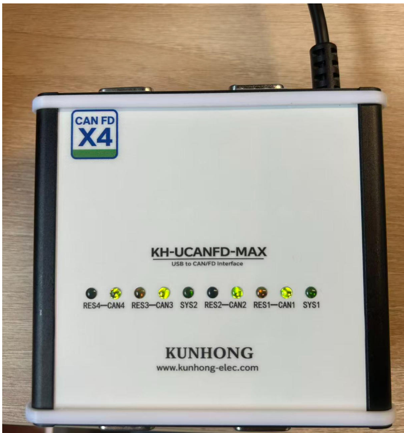
图 6 RES1、RES3 终端电阻开启示例
